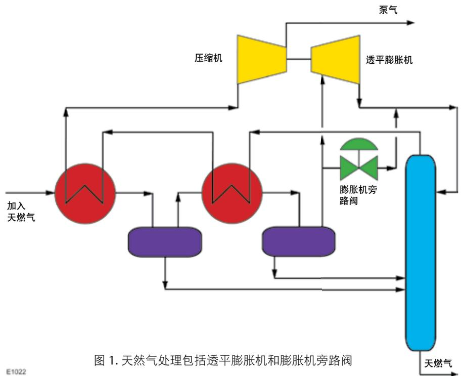
图 1. 天然气处理包括透平膨胀机和膨胀机旁路阀
